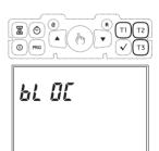
Per sbloccare la tastiera, premere nuovamente i tasti **T1**, **T2** e **T3** per 3 secondi e immettere tramite i tasti " **^** " e " **V**" la password di protezione.
